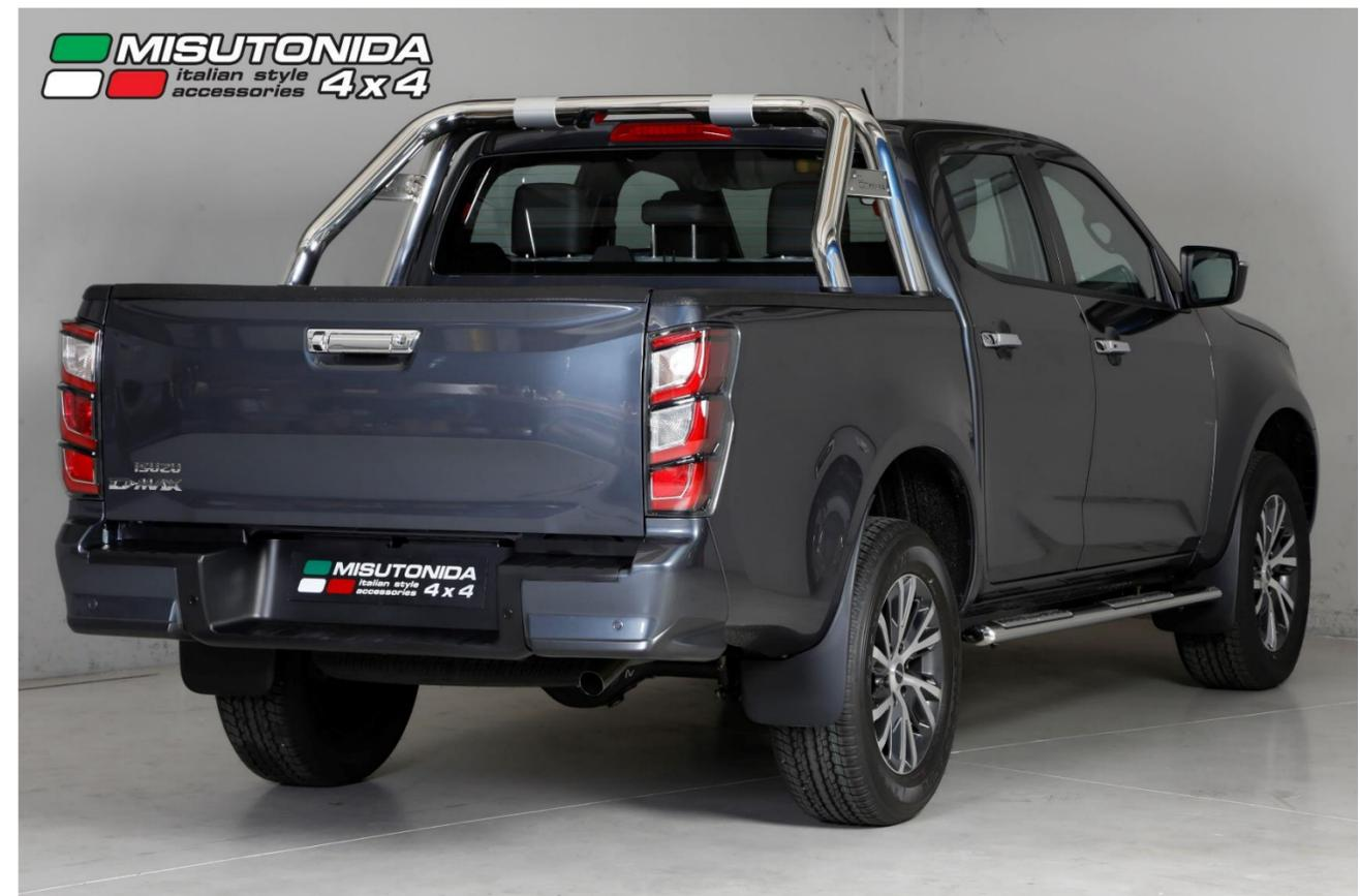
Rollbar, Hard Top, Soft Tonneau Cover y Shutter Lid solo se pueden instalar con bed liner sin bordes. Nota: Estanqueidad no garantizada.
